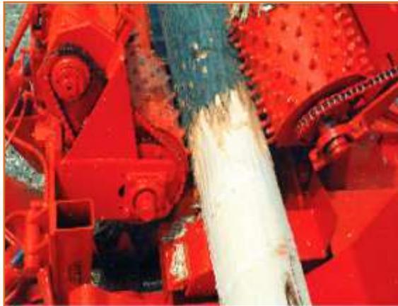
Mecanizado: utilizando una descortezadora mecánica
