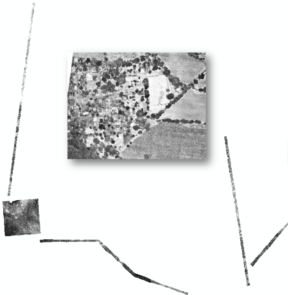
Figure 28 Imagen creada a partir de los valores de intensidad de los datos LiDAR, simulando una fotografía aérea en blanco y negro.
